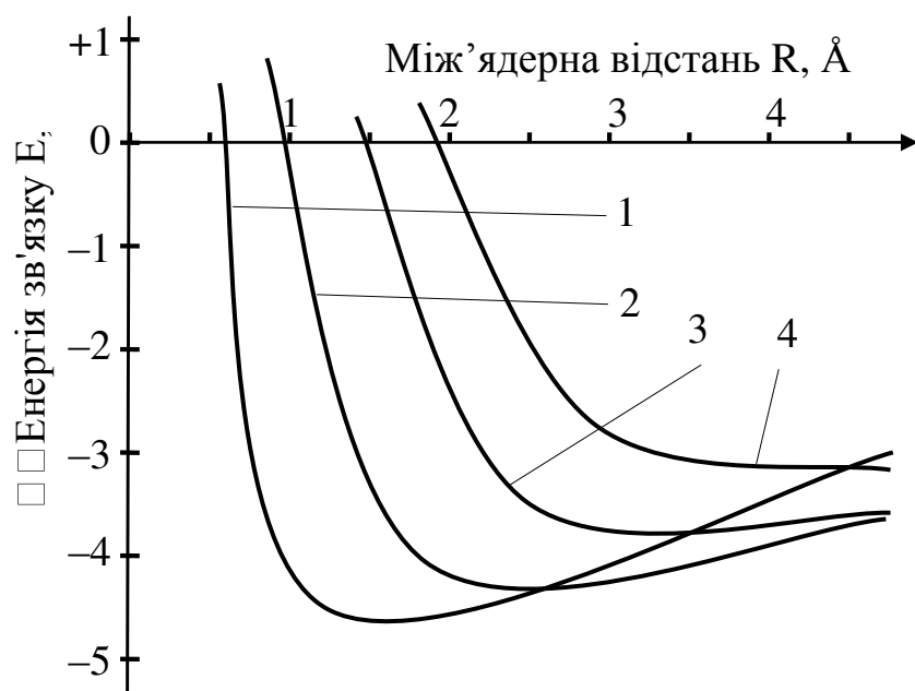
Рисунок 12 – Електронні терми на прикладі деяких вуглеводневих ланцюжків: 1 – C_2H_6 ; 2 – C_3H_8 ; 3 – C_4H_{10} ; 4 – C_6H_{14}
